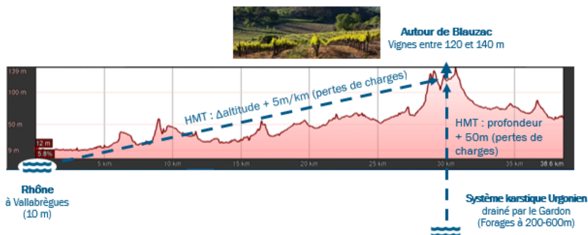
Figure 57 : Visualisation de la notion de hauteur manométrique totale – Exemple sur la zone Garrigues
